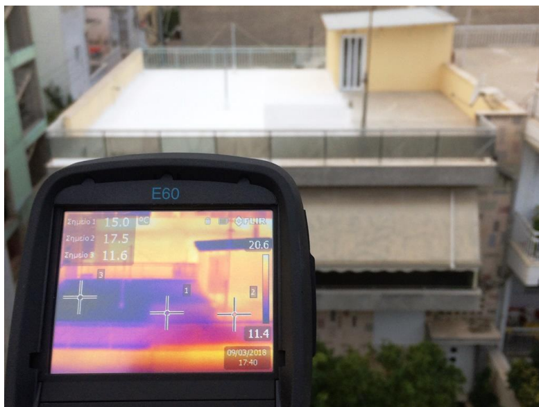
Διαφορά θερμοκρασίας μονωμένου και αμόνωτου τμήματος κατά 6°C
